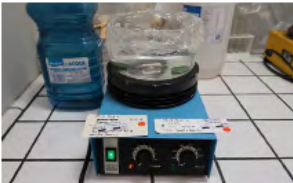
Fig. 18. Lavaggi intensivi delle monete in acqua demineralizzata. L'agitatore elettromagnetico favorisce l'estrazione dei sali solubili mantenendo la soluzione in movimento.
